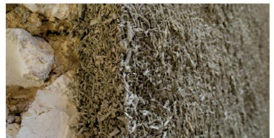
**Exemples de matériaux isolants perméables dits « respirants » : ouate de cellulose, fibre de bois, béton de chanvre**
